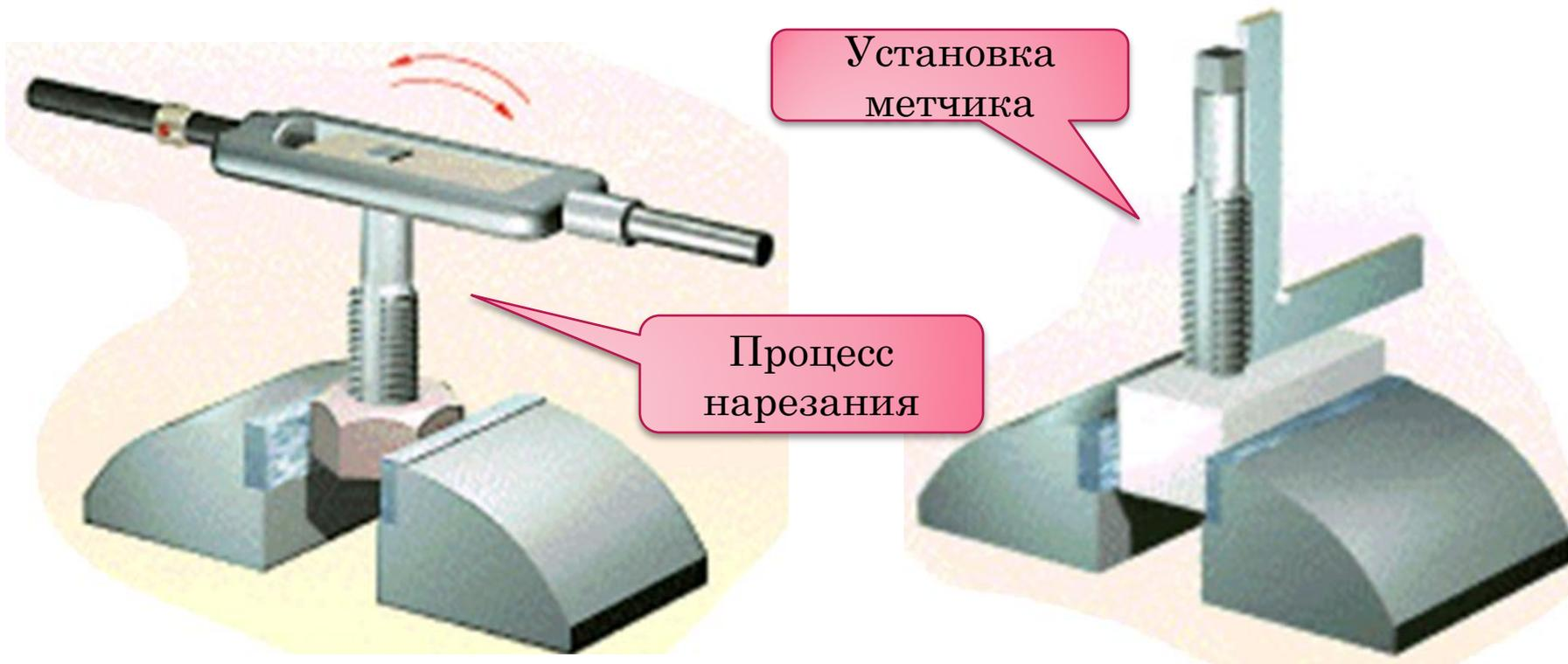
В целях облегчения работы вороток с метчиком не всё время по направлению часовой стрелки, а один - два оборота вправо и пол-оборота влево и т.д. благодаря такому возвратно вращательному движению метчика, стружка ломается, получается мелкой дробленой, а процесс резания значительно облегчается
